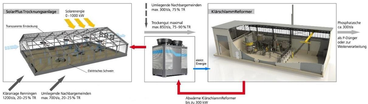
**Abbildung 1:** Konzept der Klärschlammverwertungsanlage bestehend aus Solarer Trocknung und KLÄRSCHLAMMREFORMER
