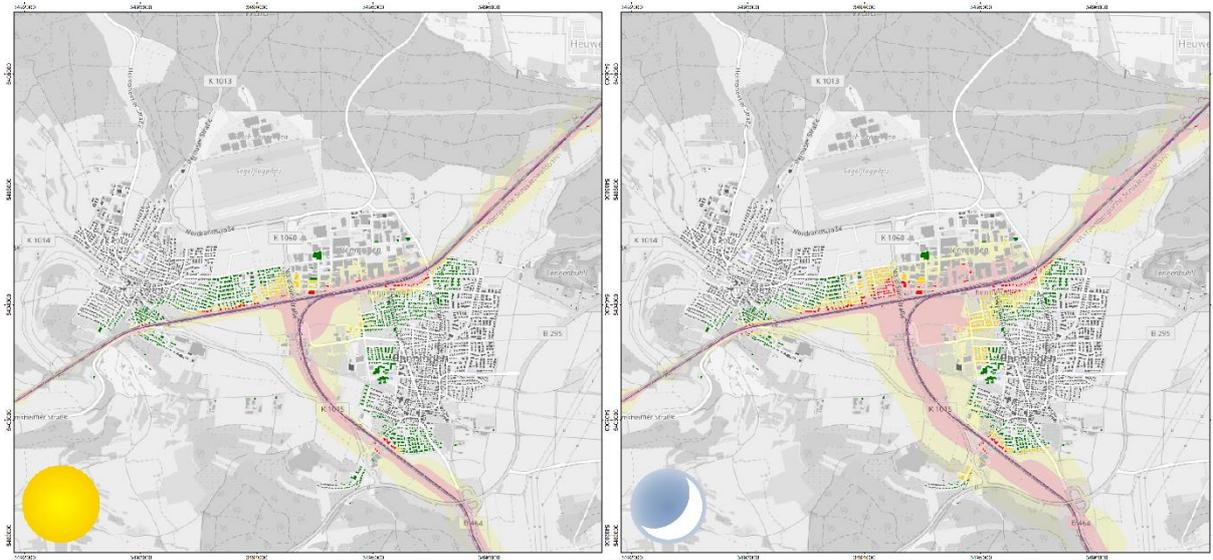
Abbildung 5: Schienenlärm, relevante Schwellen, mit Darstellung höhergelegener Stockwerke (Emission 2017, alle Stockwerke, eigene Berechnung, Ausbreitung nach VBUSch mit den Emissionspegeln des EBA, links L<sub>den</sub>, rechts L<sub>Night</sub>).
